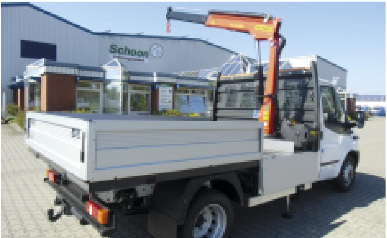
*Ford Transit Werkspritsche mit Schoon Palfinger Kranaufbau, Bordwand mit einer Steckrunge getrennt*
