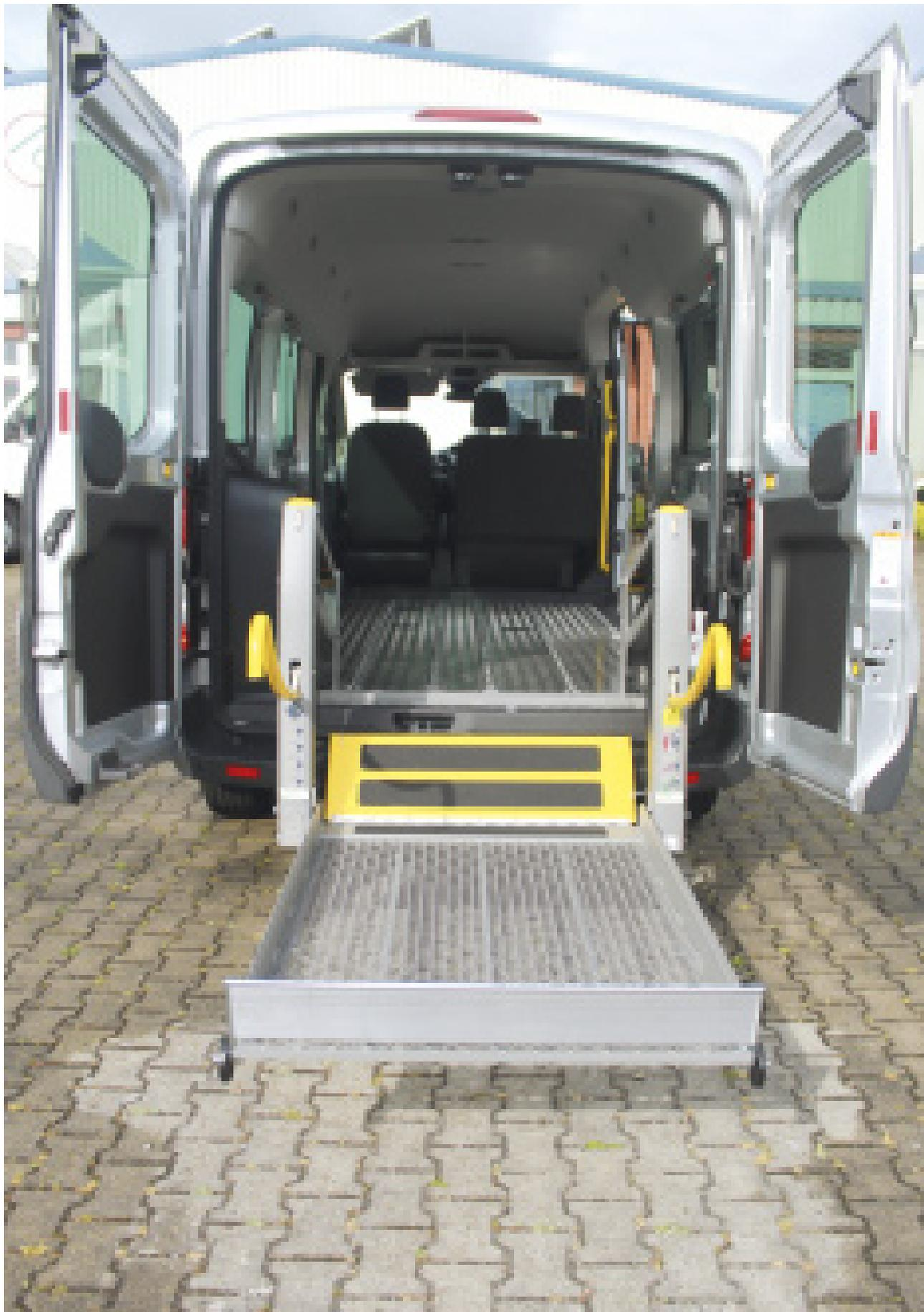
*Ford Transit mit Schoon Reha-Ausbau, Mehrzweck-ALU-Boden, Linearlift, elektrische Seitentrittstufe, Haltegriffe, QS – Rollstuhl- und Personensicherungssysteme*
