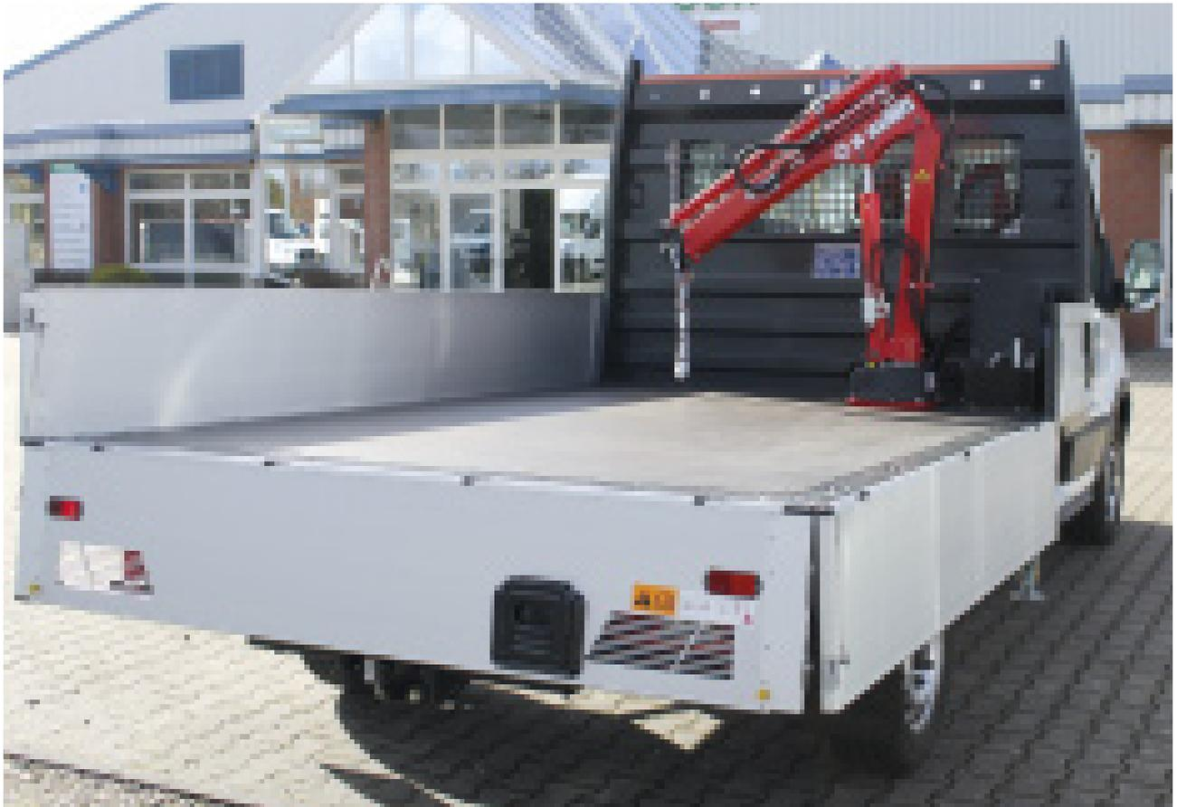
*Ford Transit Werkspritsche mit Schoon Maxilift Kranaufbau, Bordwand mit einer Steckrunge getrennt*
