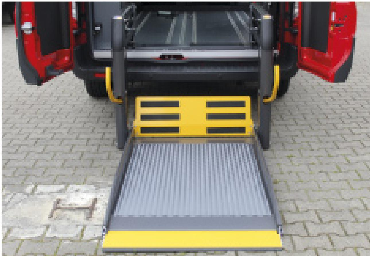
*Bus-Ausbau mit Mehrzweck-ALU-Systemboden, Linearlift, Ablagebox, QS – Rollstuhl- und Personensicherungssysteme, elektrische Seitentrittstufe, Haltegriffe*
