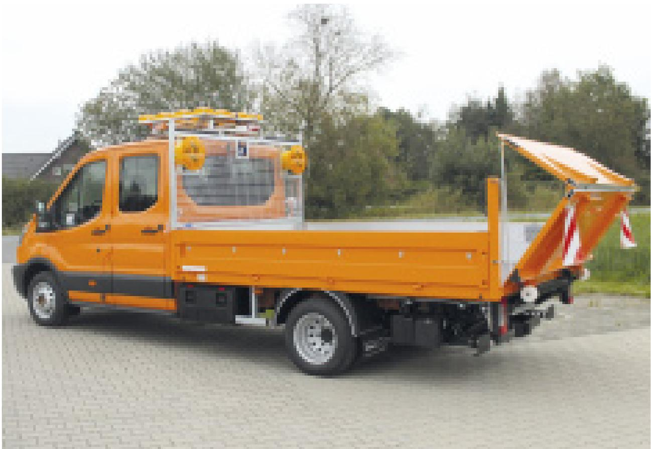
*Ford Transit mit Schoon Pritsche, faltbare Ladebordwand, Stirnwandgitter mit integrierten Blitzleuchten und Arbeitsscheinwerfer, Blinkpfeilanlage, Netzhaken, Kunststoffboxen, Lackierung*
