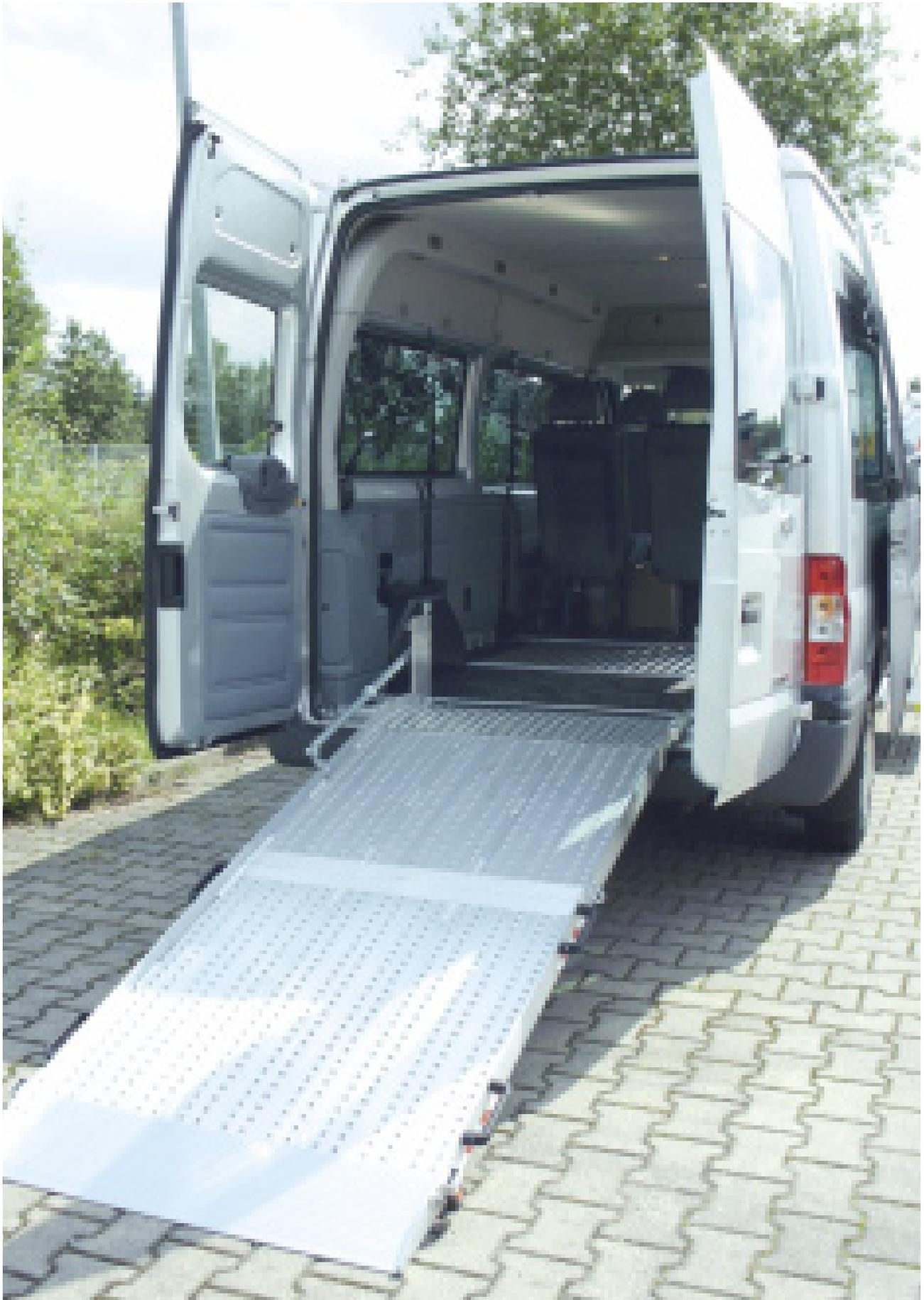
*Ford Transit mit Schoon Reha-Ausbau, BIG Rollstuhlrampe, elektrische Seitentrittstufe, Haltegriffe, QS – Rollstuhl- und Personensicherungssysteme*
