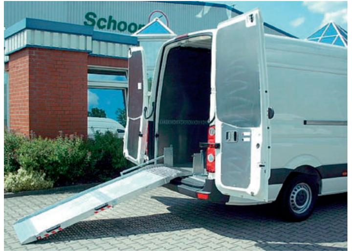
Die schwenkbare falt-Auffahrrampe bietet freie Sicht nach hinten und gewährt Zutritt. Nach innen und außen schwenkbar
