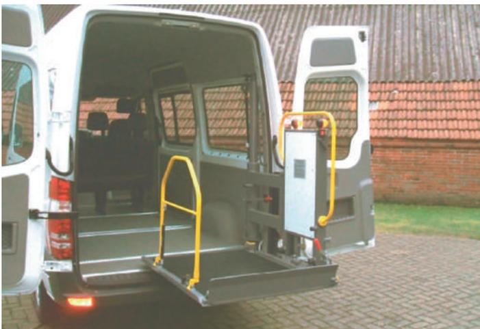
Der Schwenklift wird für den Bereich „Eingeschränkte Mobilität“, aber auch für den Bereich der Güter- und Rollcontainer eingesetzt
