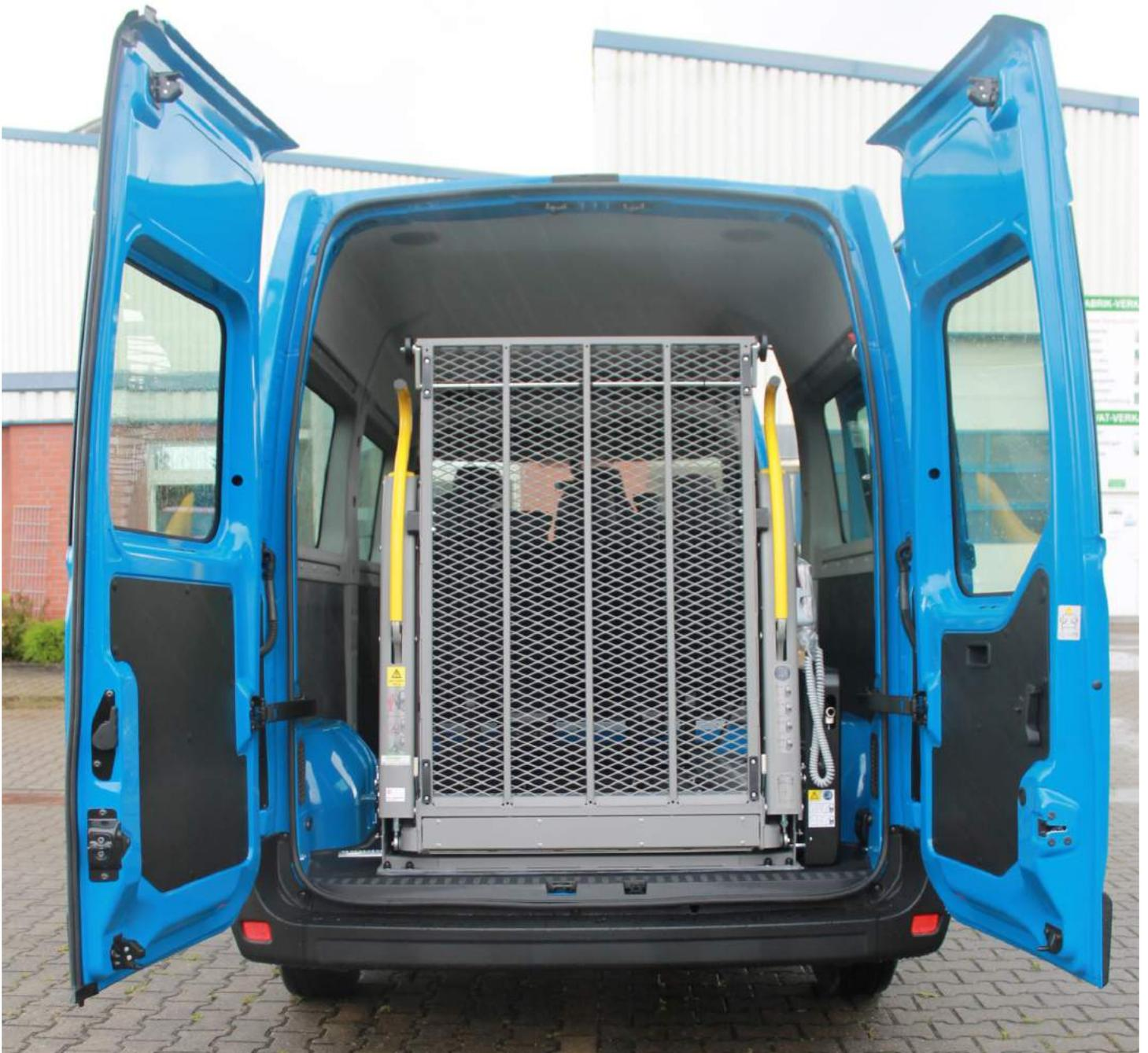
Ein Linear-Lift hebt gerade nach oben, danach klappt die Plattform gerade nach oben.
