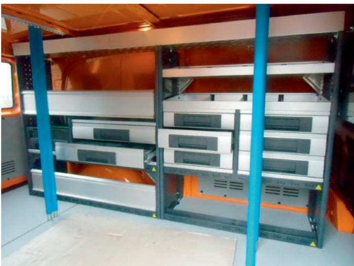
Horizontale Sperrstangen in Verbindung mit Zurrseilen im Boden und unter dem Dach
