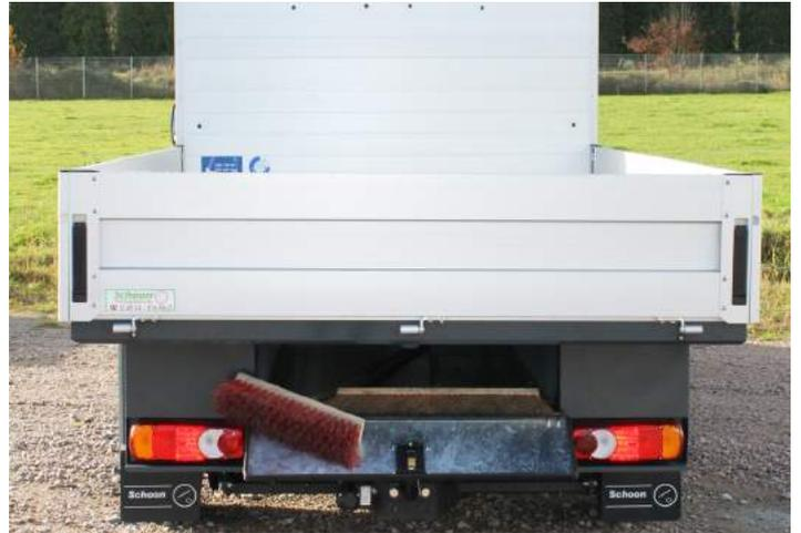
Zum Einschub von Langmaterial mit Siebdruckboden
