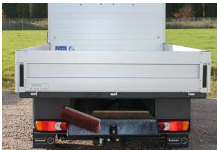
Zum Einschub von Langmaterial mit Siebdruckboden
