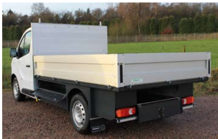
Heckfach und Seitenfächer sind abschließbar
