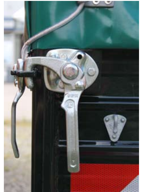
Winkelhebelverschlüsse an Stahlbordwänden sehr gut auch mit Handschuhen zu bedienen!
