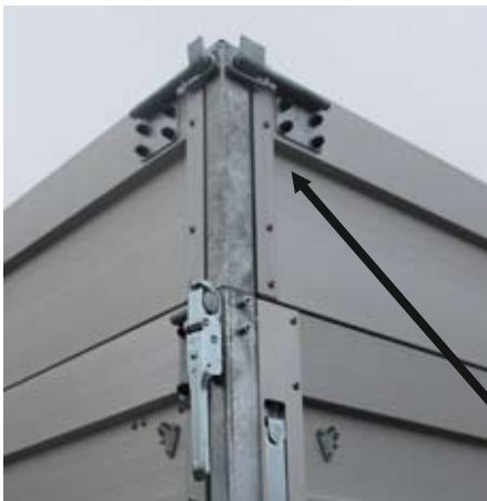
Eingelassene Langwegverschlüsse (keine herausstehenden Kanten/Hebel) bei Aluminium-Hohlkammerprofil (mit Holz in der Hohlkammer verstärkt) robust und leicht
